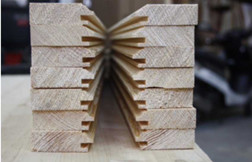
Auf der Tischfräse wird ein Profil an die aufrechten Rahmenhölzer gefräst.
